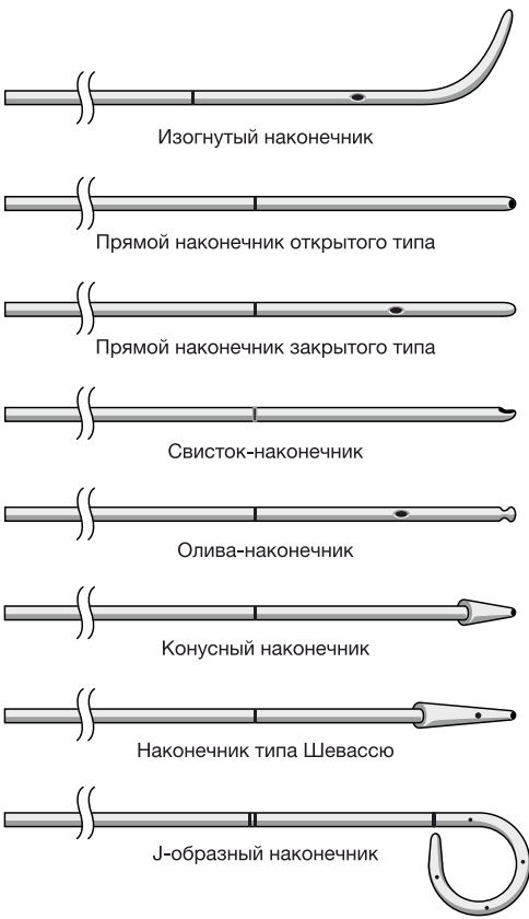
Рис.2. Варианты исполнения наконечника изделия
